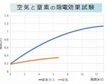
イオナイザーガンの射程は上記グラフの通りで小さな部品やデバイスの除電に適しています。ガラス基板等(+)に帯電しやすい物質に特に効果があります。
