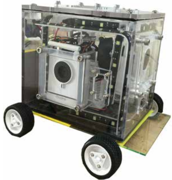
インフラ系劣化診断システムのMVP
